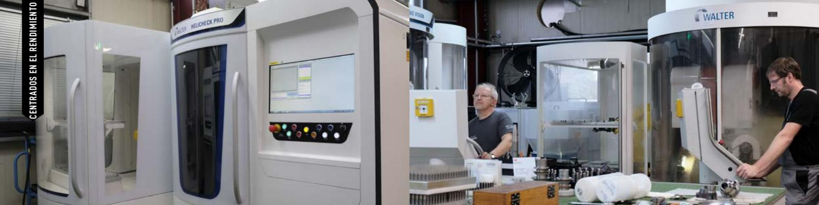
Máquina Helicheck Pro para la medición completamente automatizada de herramientas
