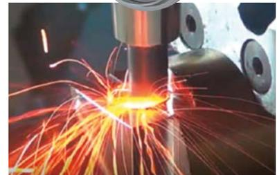
Las fresas cerámicas son capaces de mecanizar aleaciones termorresistentes utilizadas en motores que son imposibles de trabajar a alta velocidad con las herramientas de metal duro existentes debido a la temperatura generada durante el mecanizado.
